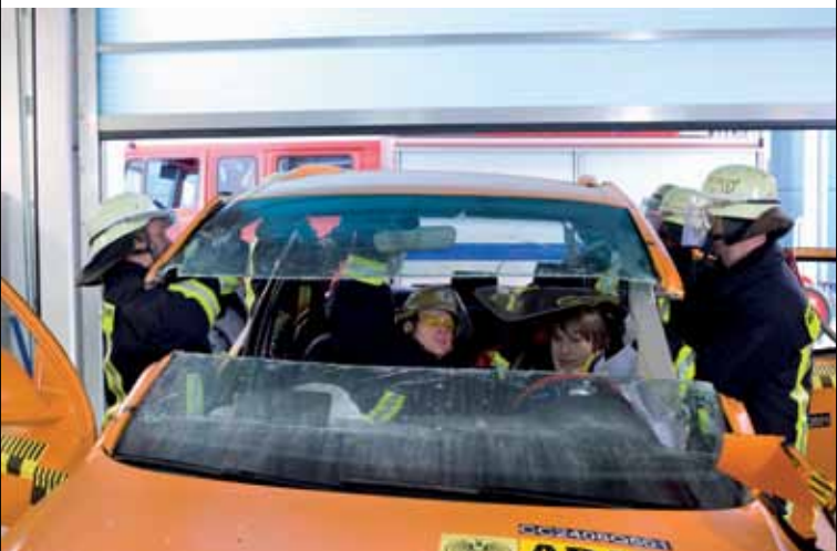
4. Abnehmen des Fahrzeugdachs
