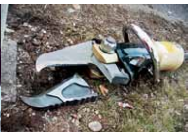
... daran zerbrochene Rettungsschere
