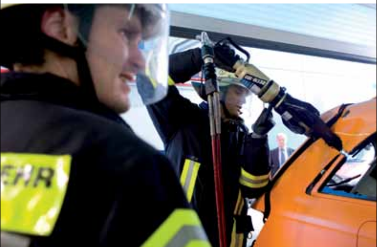
3. Schnitt durch die C-Säule
